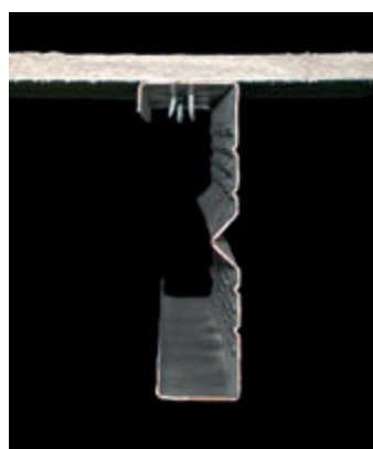
Abb. 3: Für neuartige und nicht genormte Ausführungen kann eine Ausführung als „geprüftes System“ mit AbZ oder AbP erfolgen. Hier am Beispiel von neuartigen Befestigungen von Gipsplatten auf Metallprofilen mit ballistischen Nägeln (VHT Darmstadt)
