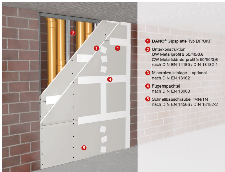
Abbildung 36 – Schachtwand
