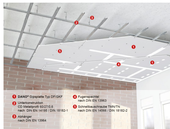
Abbildung 68 - Unterdecke F 60-A (15 + 18 mm DANO® Feuer DF/GKF)
