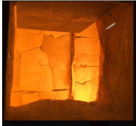
Abbildung 17 - Durchführung der Brandprüfung
