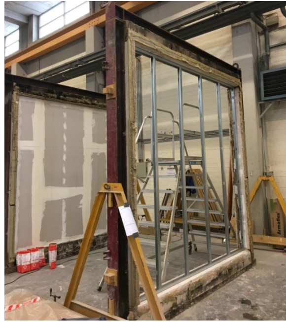
Abbildung 15 - Aufbau der Trennwand in einem Prüfraum
