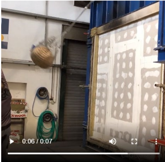
Abbildung 39 - Mechanische Beanspruchung einer Brandwand
