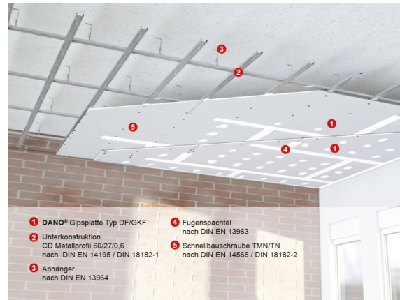
Abbildung 66 - Unterdecke F 30-A (2 x 12,5 mm DANO® Feuer DF/GKF)
