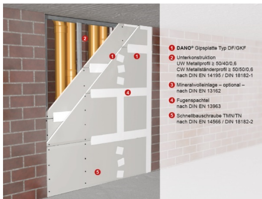
Abbildung 48 - V 90-21 - Vorsatzschale / Schachtwand F 90-A
