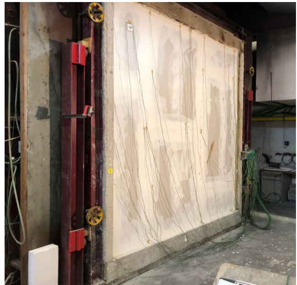
Abbildung 16 - Anordnung von Messstellen (Temperatur)
