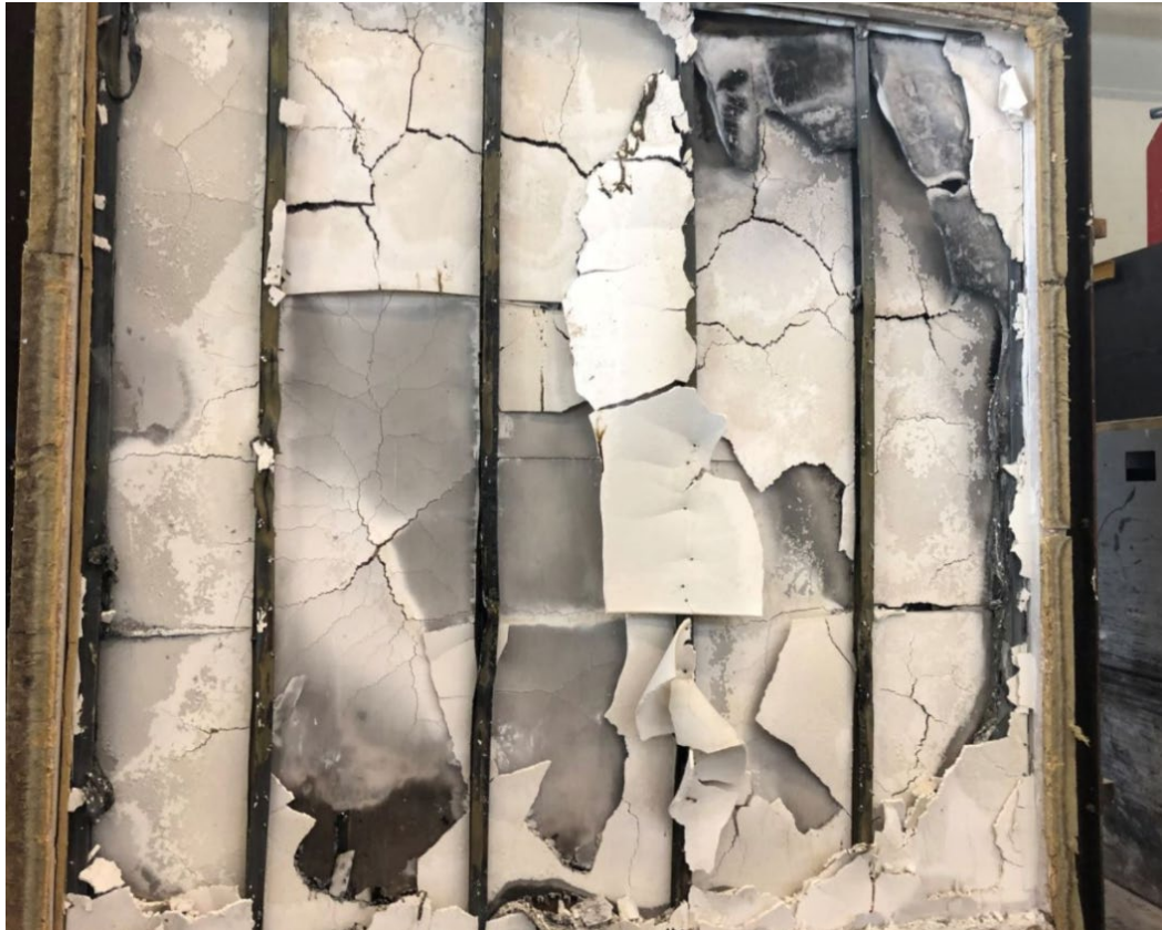
Abbildung 38 - Trennwand mit einer Beplankung aus 2 x 12,5 mm DANO® Bau A/GKB nach einer Brandbeanspruchungsdauer von 60 Minuten.
