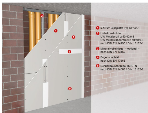
Abbildung 47 - V 60-10 - Vorsatzschale / Schachtwand F 60-A
