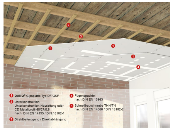
Abbildung 67 - Unterdecke F 30-B (2 x 12,5 mm DANO® Feuer DF/GKF)
