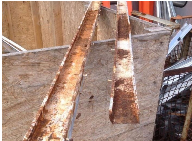
Abbildung 7 - Korrodierte Trockenbauprofile
