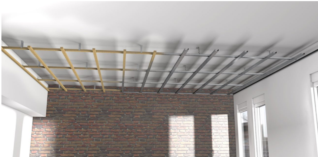
Abbildung 12 - Unterkonstruktionen von Unterdecken
