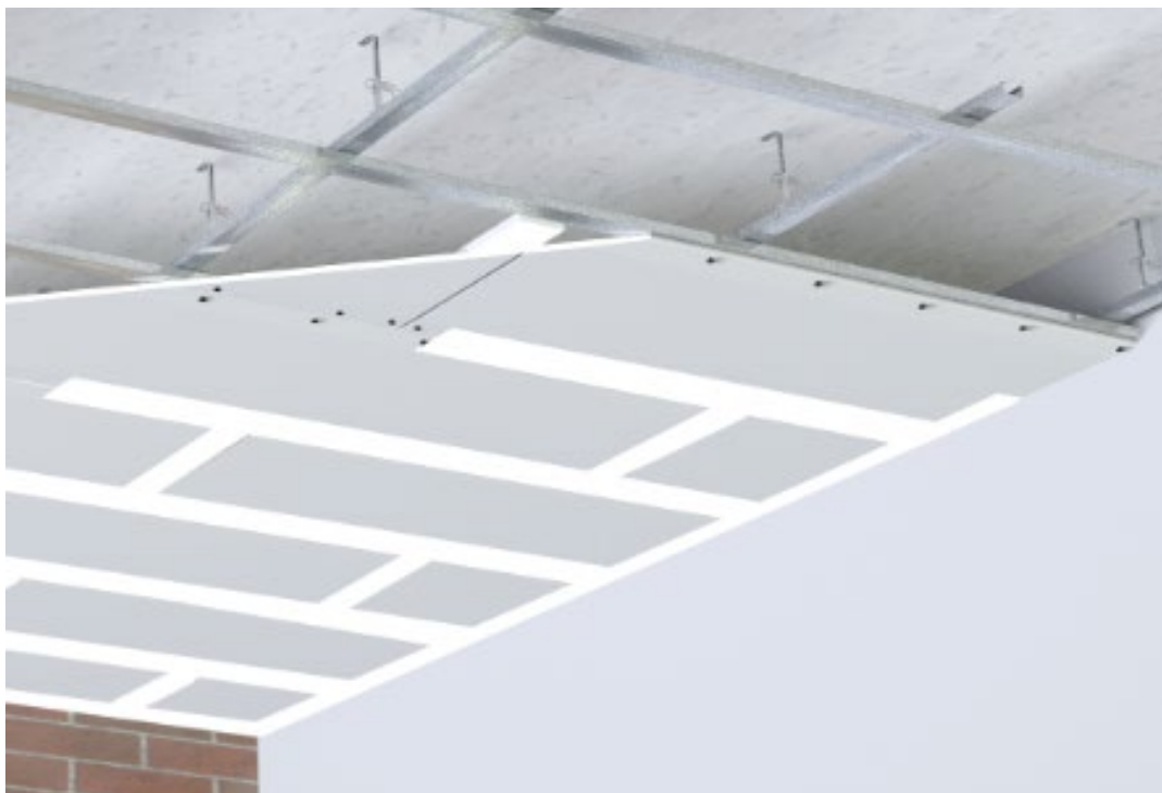
Abbildung 55 - Anschluss Unterdecke an Trennwand
