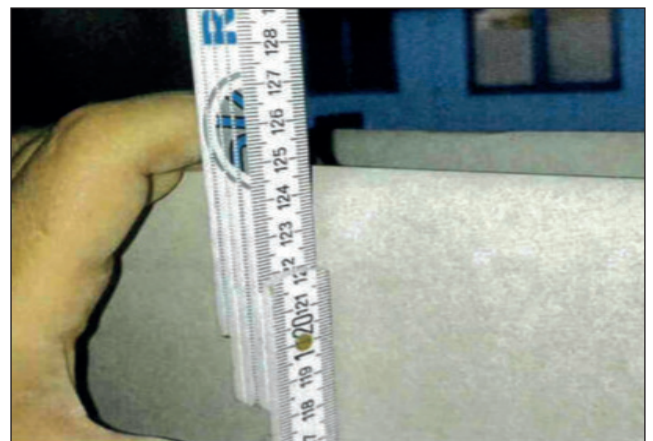
Bild 5: Ablesen Plattenbreite auf Plattensichtseite mit Gliedemaßstab (ungenau, nicht definierbar)
