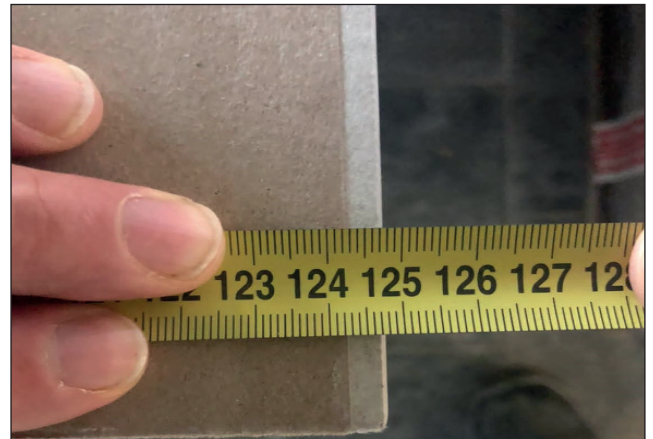
Bild 3: Bestimmung der Plattenbreite
